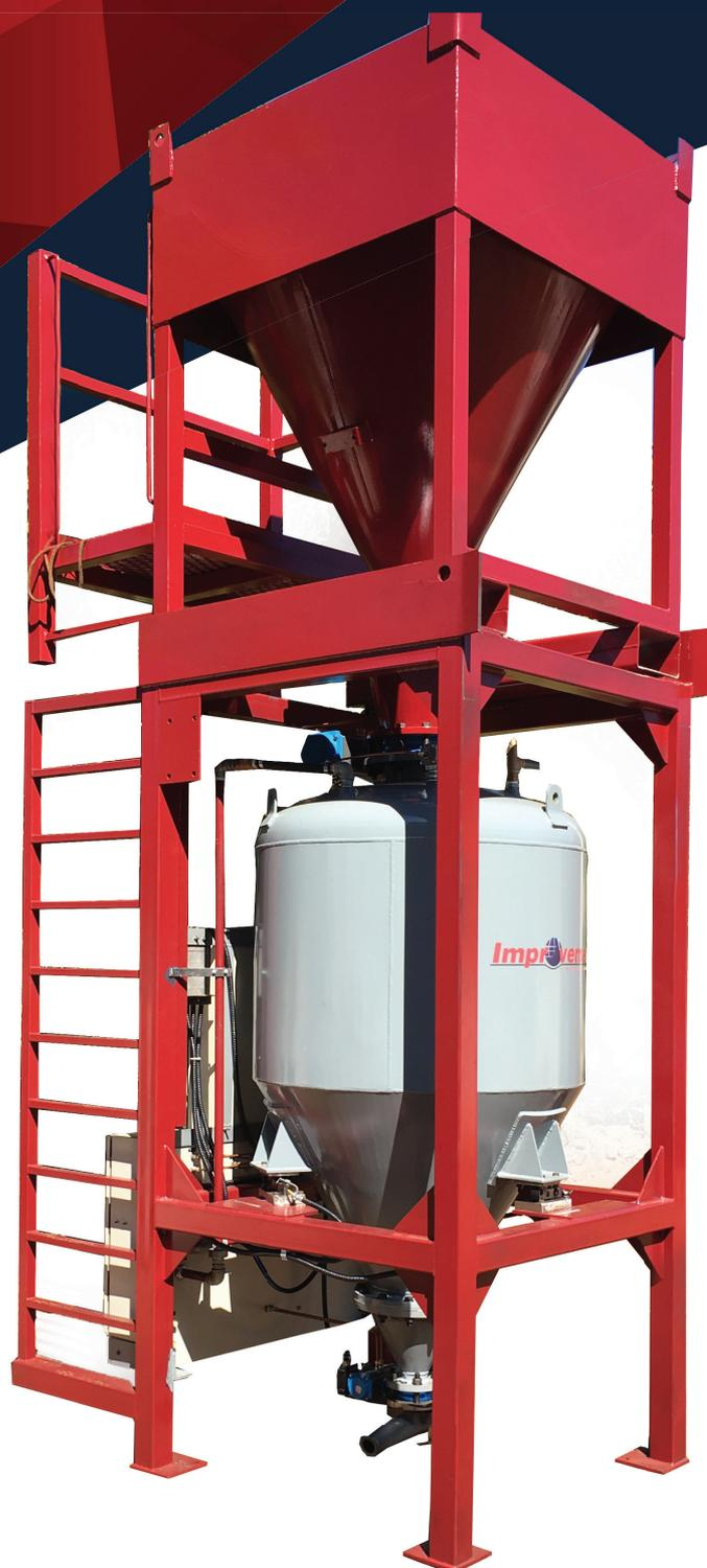
Este equipamento foi concebido para ser de fácil utilização, robusto e bem adaptado às condições existentes nas usinas siderúrgicas, sendo amplamente utilizado na Indústria Siderúrgica para execução de reparos em Fornos Elétricos a Arco, Fornos AOD, LD, Painéis de Aço, etc., em condições de alta temperatura.
